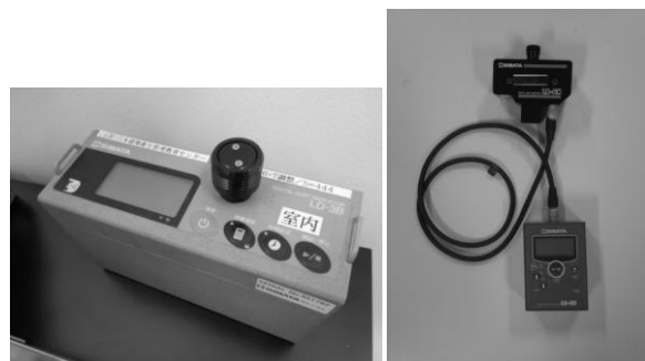
図 1 デジタル粉塵計 LD-3B(左)と LD-6N(右)
